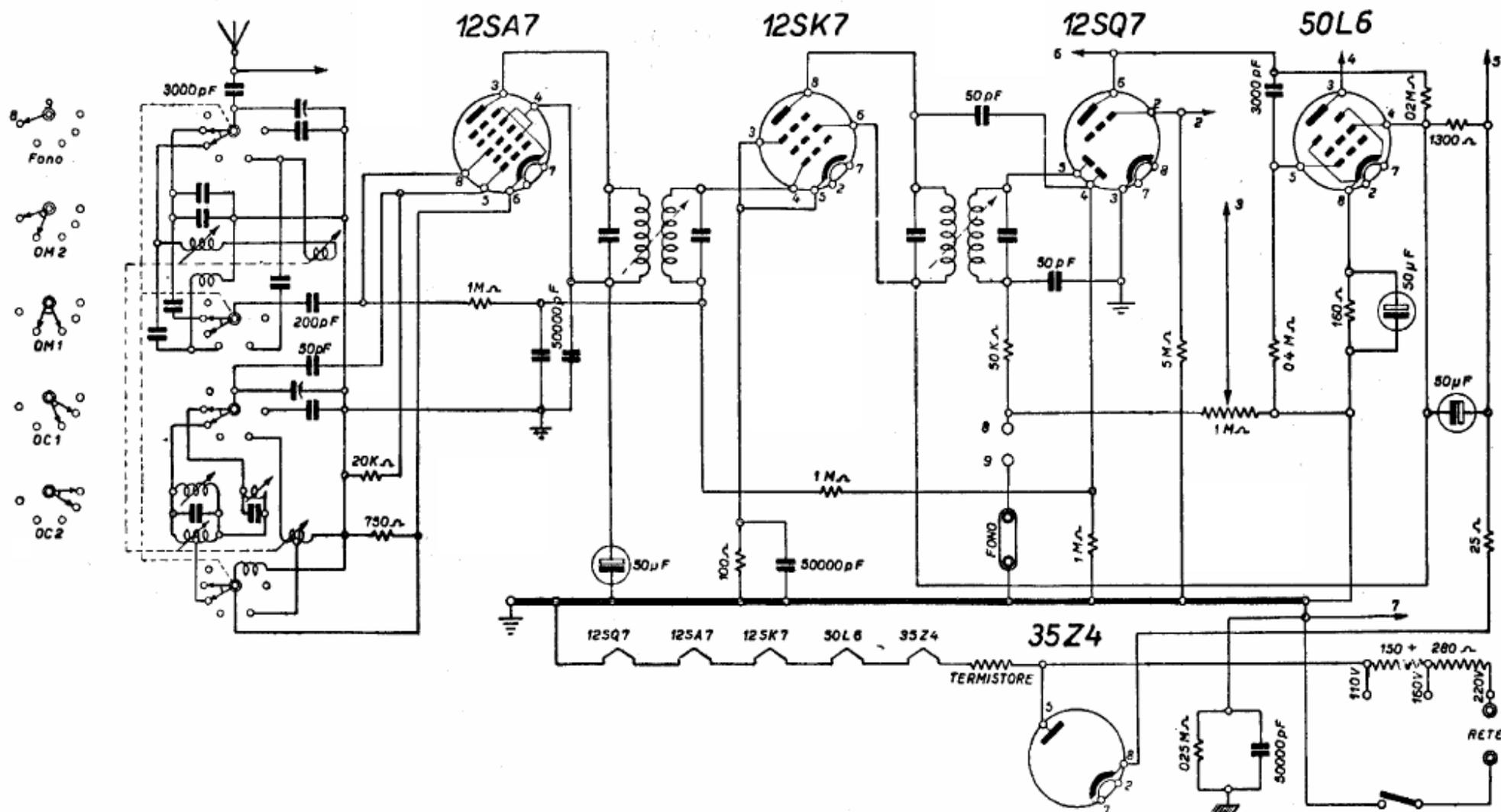
REOM - Sintomagic Radio mod. a10 - Gamma onde medie divisa e due bande onde corte. Notare che nello schema non è indicato l'altoparlante, il quale è invece presente nell'apparecchio multivox, riportato a parte. La caratteristica di questo modello è di funzionare da interfono, consentendo conversazioni bilaterali ad alta voce, nonché riproduzione dei programmi radio in altro ambiente.
